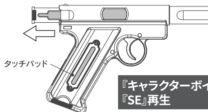
タッチパッドを触ると、ボルトが展開し発光
